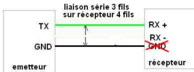
La tension entre Rx + et Rx - variera entre + 5 Volts et - 5 Volts :IMPORTANT ,NE PAS RELIER LE RX- à la MASSE
