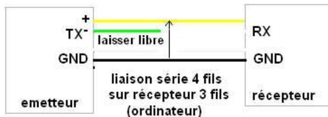
C' est ce schéma par exemple de la sortie série 38400 bauds des VHF AIS Navicom ou Radio Océan; les fils sont bleu et gris plus la masse , entre bleu et gris c' est une liaison RS422 et entre bleu et la masse une liaison RS232.
