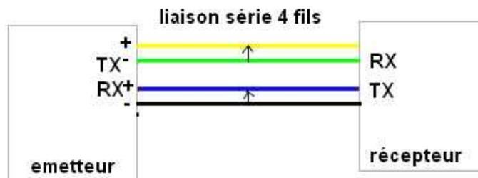
La tension de à 5 Volts est envoyée entre + et - ( niveau 0) ou entre - et + ( niveau 1)
