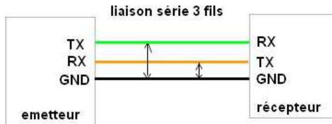
les tensions varient de +5 Volts (niveau 0) à -5 Volts (niveau 1) par rapport à la masse (GND), voir tableau ci dessous)
